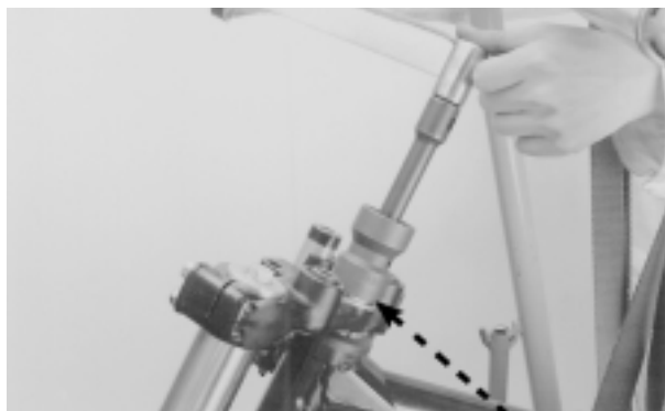
PORCA DA COLUNA DE DIREÇÃO PARAFUSO
